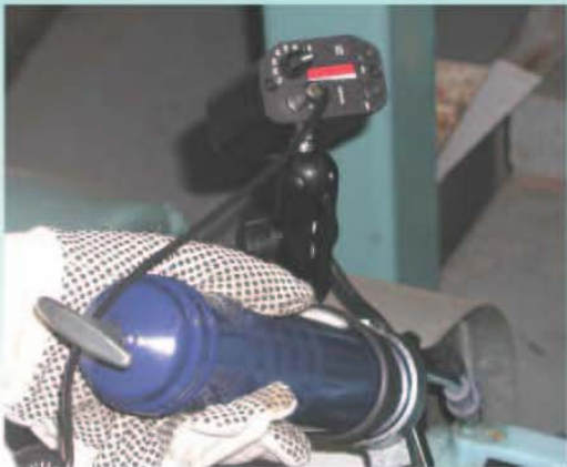
El Ultraprobe 201 Grease Caddy Gira izquierda/derecha y arriba/abajo para ángulos difíciles.
