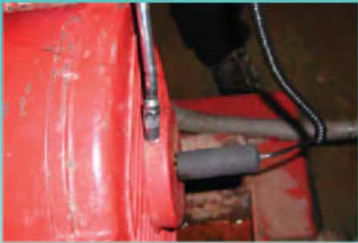
El montaje magnético facilita la ubicación del sensor en muchas chumaceras.
